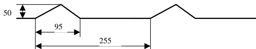
图 6 振动干扰测试路面条件要求示意图
